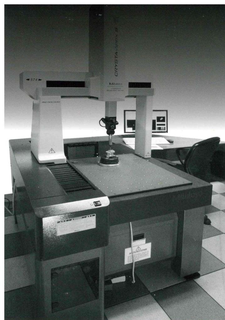
**Controllo dimensionale con macchina di misura a coordinate**
